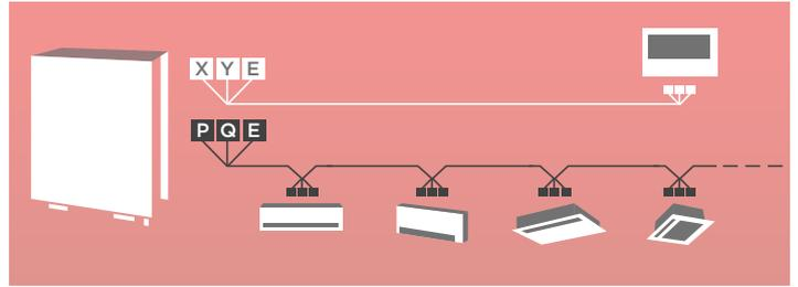
Para una fácil instalación y configuración, el cableado de comunicación puede ser compartido por múltiples unidades evaporadoras y condensadoras.
